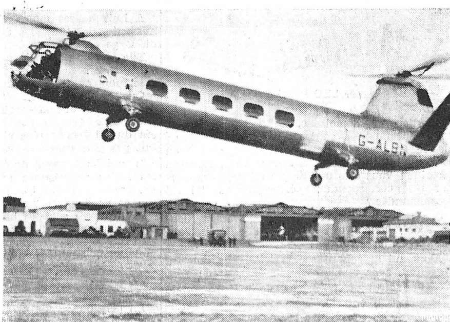
Le premier hélicoptère anglais propulsé par deux rotors, le Bristol 173, vient de terminer ses vols d'essai à Filton près de Bristol. Ce véhicule peut transporter 13 passagers et atteint une vitesse maximum de 220 km. à l'heure. Sa vitesse moyenne est de 170 kmh. environ. On espère mettre en service, déjà l'année prochaine, les premiers hélicoptères de ce type. Ils serviront au trafic intervilles, tel Londres - Birmingham.
