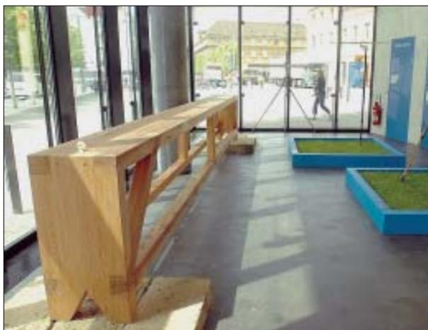
«Niveler l'espace». Ancêtre du niveau, ce chorobate de 6 mètres de longueur a été fabriqué pour l'exposition. Cette sorte de table permettait aux Romains de calculer les pentes. Exemple: l'aqueduc de Besançon présentait une pente moyenne de 0,22% sur 9900 mètres, soit 22 mètres de différence de niveau.
