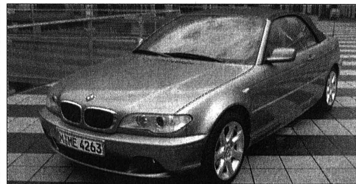
La commande entièrement automatique ouvre ou ferme la capote en 25 secondes. (Idd)
