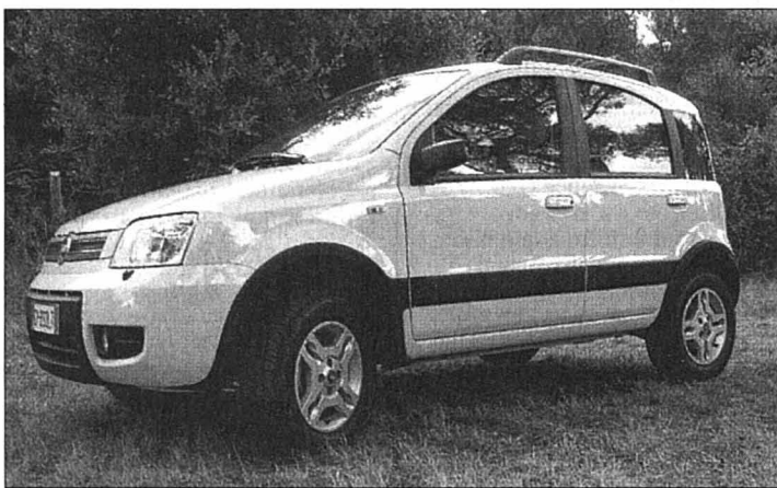
L'effet de l'augmentation de la garde au sol et la présence de boucliers de protection ne se limitent pas au look de cette véritable tout-terrain. (l'dd)
