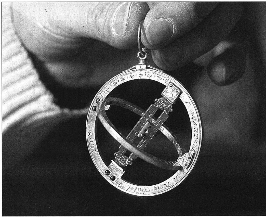
Après avoir réglé la latitude et le mois sur le curseur et orienté l'anneau solaire face au soleil, l'heure se marque par un point lumineux à l'intérieur de la lunette. PHOTO GALLEY
