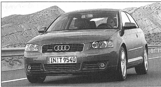
Les jantes de 17 pouces chaussées de pneus 225/45 ne nuisent pas au confort de l'Audi A3 3.2.
