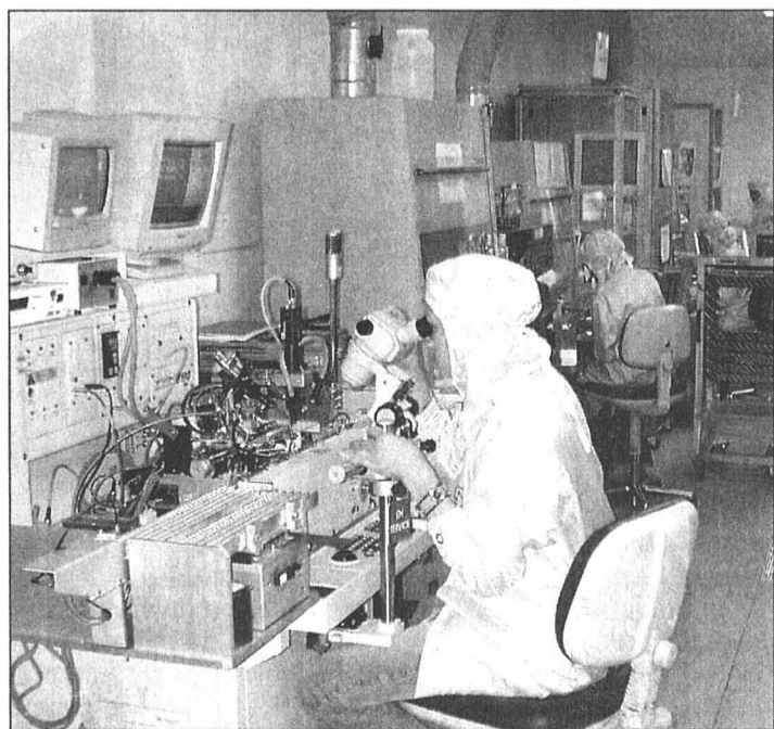
La fabrication de capteurs se fait en salle blanche. PHOTO SP
