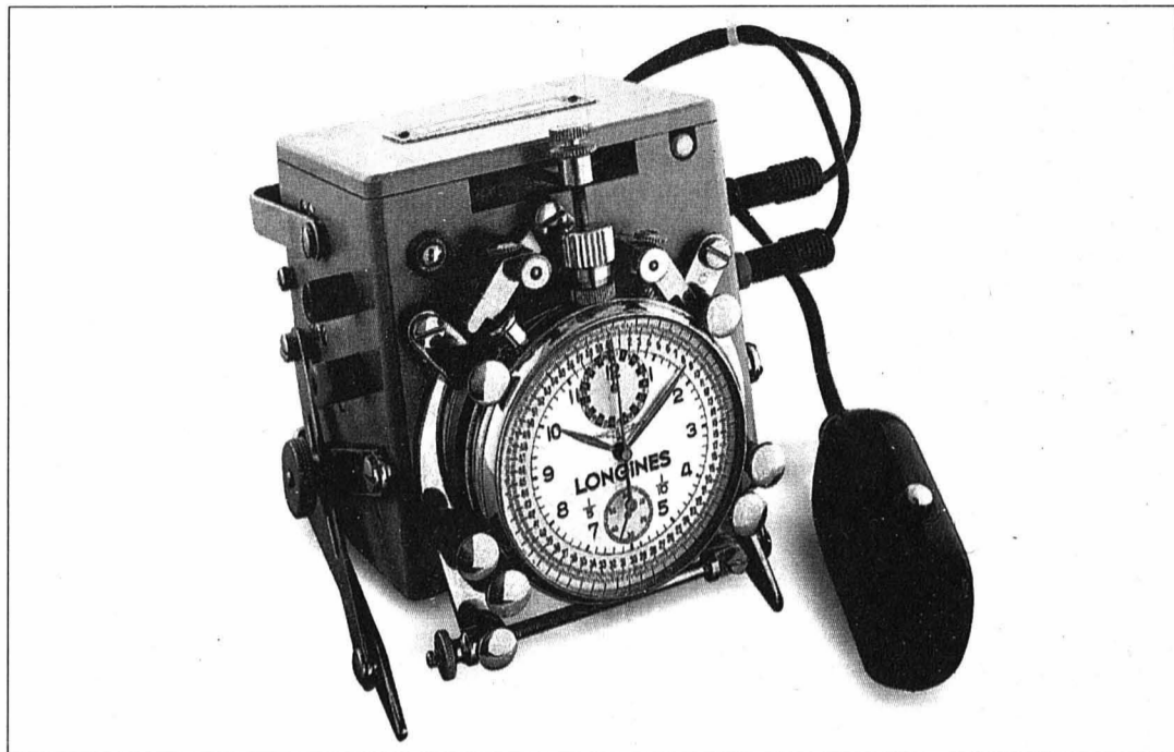
Un coffret de chronométrage avec chronographe-compteur mesurant au 1/10e de seconde. PHOTO SP
