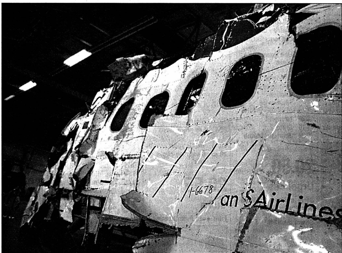
Les enquêteurs ont en partie reconstitué le fuselage du MD-11.
