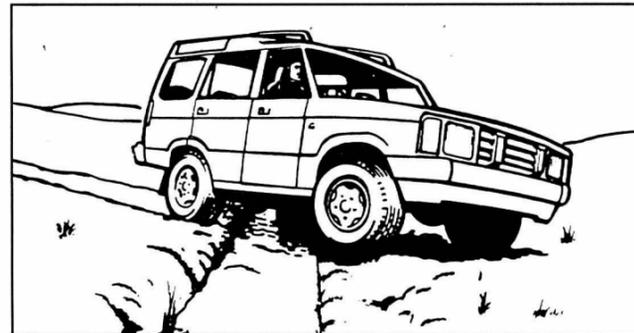
Attaquer un fossé - Les quatre roues doivent passer une à une dans le fossé, d'où l'utilité d'un grand débattement de suspension.
