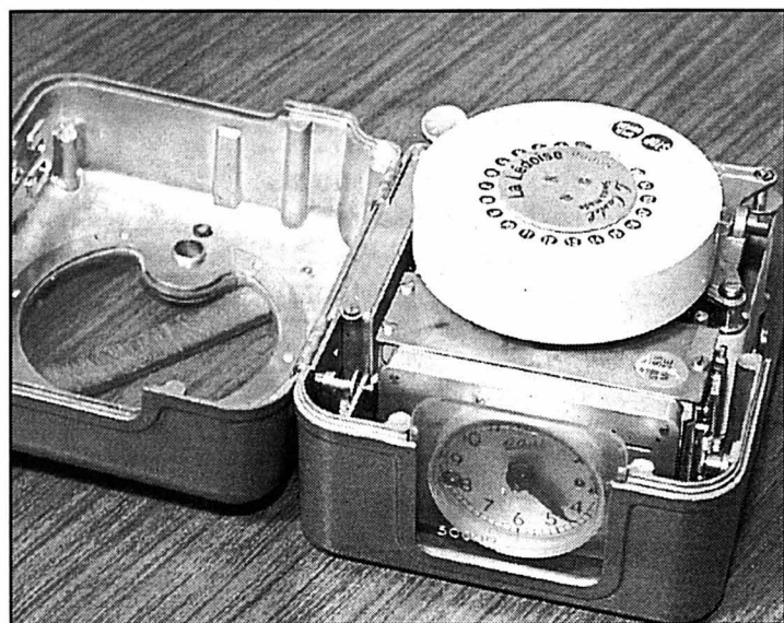
Un constateur, machine à calculer le temps de vol des pigeons, commandé par une boîte belge, la Lédoise, à l'entreprise Le Castel. photo Leuenberger
