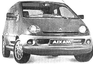
Plaque interchangeable avec celle d'une moto! Peut être conduite avec les catégories de permis A1, A2, A et B. Vitesse maximale env. 100 km/h. Consommation: 2,8 litres Diesel / 100 km. Utilisation très simple, pas de changement de vitesse ni de débrayage grâce au système Variomatik. Disponible également pour la catégorie F - 45 km/h à partir de 16 ans et la catégorie G - 30 km/h à partir de 14 ans.
