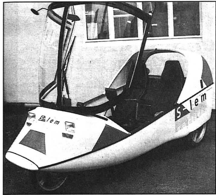
Ce véhicule électrique au design futuriste permet à deux personnes de circuler 60 kilomètres, avec des pointes de vitesse de 95 km/h, pour un coût réduit. photo Leuenberger
