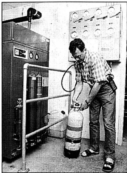
1) «GONFLAGE» - A l'aide d'un compresseur, Jean-Claude Maradan, du Centre international de plongée, remplit une bouteille.
