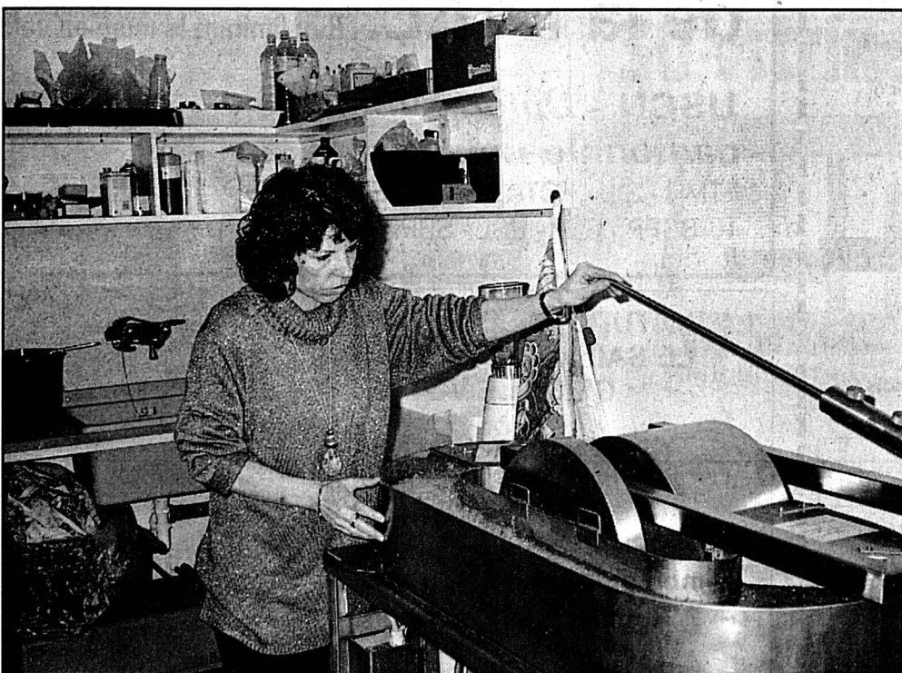
MARIE-CLAUDE MEIER - L'artiste vide la cuve de la pile hollandaise pour récupérer la pulpe qui lui sert de matière première pour la confection du papier. ft-Æ
