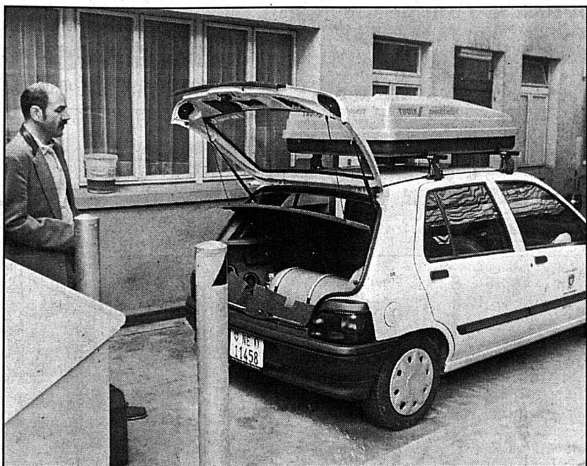
VOITURE À GAZ - La bombonne d'alimentation est placée dans le coffre, les outils sont relégués sur le toit!
