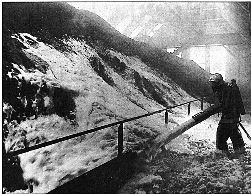
AUTOCOMBUSTION - Ce n'est pas une «space party», mais bien un pompier qui lutte contre la combustion spontanée du charbon. Avec de la mousse, car l'eau pourrait attiser les braises.
