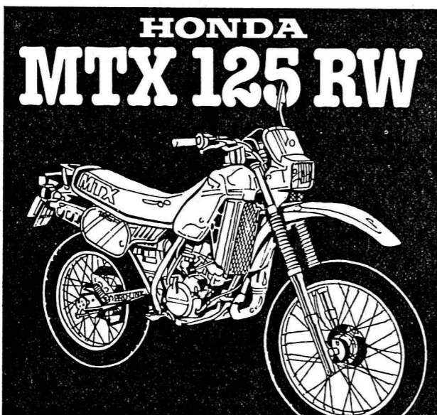
1 cylindre, 2 temps, 124 cm 3 , 20,4 CV à 7000/min! 6 vitesses. Freins: tambours. Suspension Pro-Link. Réservoir 9 l. 99 kg. Env. 115 km/h.
