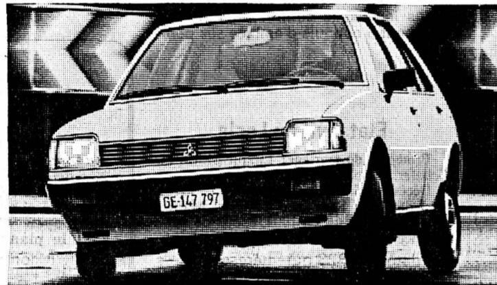
Mitsubishi Colt 1400 GLX. 3 et 5 portes, traction avant, boîte Super-Shift ou Automate, direction à crémaillère, suspension à roues indépendantes.
