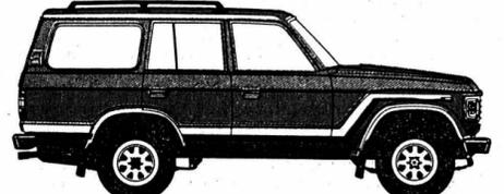
Toyota Land Cruiser Station Wagon G Deluxe. Traction sur les 4 roues. 5 places. Moteur 6 cylindres, de 4228 cm<sup>3</sup>, 88 kW (120 CV) DIN. Pour fr. 32 590.-.
