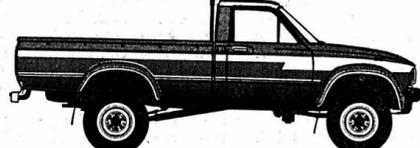
Toyota Hi Lux 4 x 4 Pick Up. 65 kW (89 CV) DIN. Jusqu'à 970 kg de charge utile. Existe avec empattement 2585 mm et 2800 mm. A partir fr. 17 890.-.
