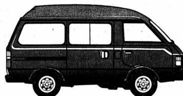
Toyota Lite Ace 1300 combi. Jusqu'à 9 places. 43 kW (58 CV) DIN. Jusqu'à 790 kg de charge utile. Version Wagon Deluxe. Avec toit normal ou surélevé. A partir fr. 13 550.-.
