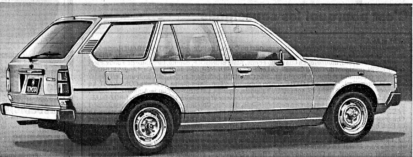
Corolla 1300 break 1290 cm 3 , 44,1 kW (60 ch DIN)
