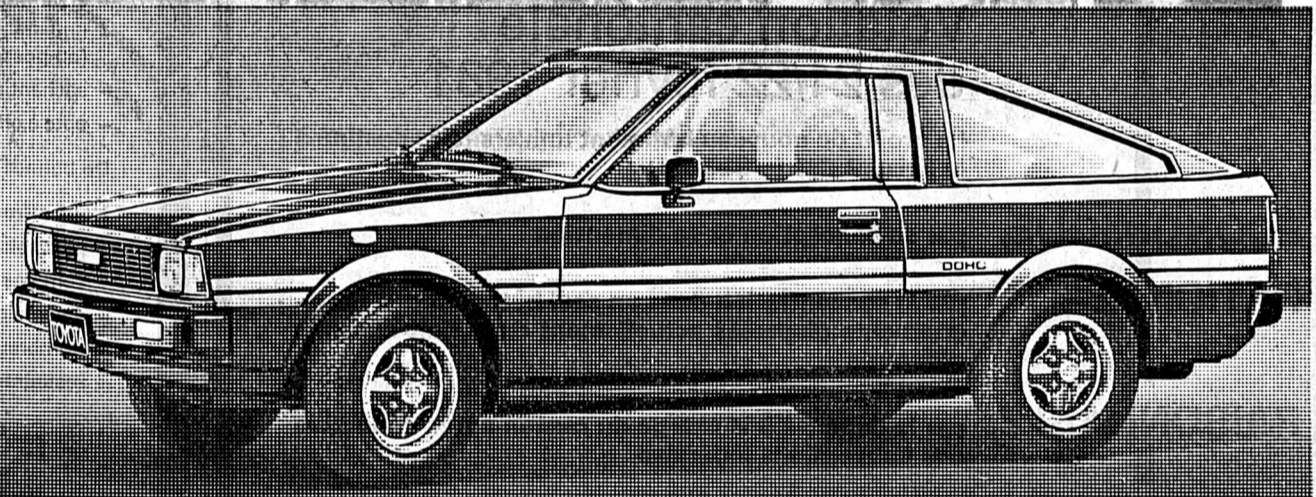
Corolla 1600 GT coupé, 1588 cm 3 , 79,4 kW (108 ch DIN), 2 arbres à cames en tête, 2 carburateurs double-corps horizontaux, 5 vitesses
