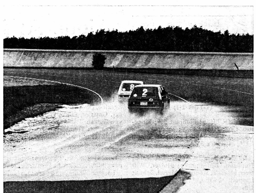
Lors des essais, les voitures N° 2 (dotée de pneus à 2 mm) et N° 8 (dotée de pneus de 8 mm) traversent à la vitesse de 80 km/h un secteur de route recouvert de 4 mm d'eau. Alors que la voiture équipée de pneus de 2 mm se met à flotter et quitte tangentiellement la piste circulaire, celle équipée de pneus de 8 mm peut encore être maîtrisée malgré un léger dérapage.
