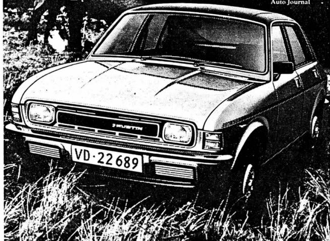
1272 cmc, 41,9 kW DIN (57 CV DIN), traction AV, suspension compound Hydragas inusable, 4 portes, moquette, appuis-tête à l'avant, sièges-couchettes recouverts d'étoffe, compte-tours.
