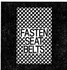
Ce signal lumineux et acoustique fonctionne aussi longtemps que vous n'avez pas attaché votre ceinture de sécurité 3 points à enrouleur automatique.
