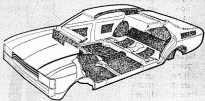
Isolation acoustique: Isolation totale des bruits de roulement et des bruits de moteur grâce à l'utilisation de couches de matériaux isolants incorporés dans la carrosserie et dans l'habitacle.
