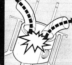
Moteurs «Flow thru»: Tous les moteurs Granada sont construits selon la technique «Flow thru» garantissant une meilleure respiration du moteur, une combustion optimale. Résultat: plus de puissance pour une consommation d'essence minimale.
