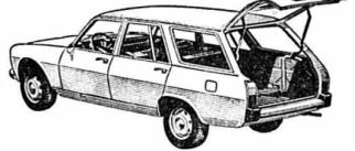
Ces breaks 5 portes existent dans les versions 204, 304 et 504 aux moteurs de 1,1 à 2 litres. Ils offrent 5 ou 7 places et une charge utile de 410 à 670 kg. Les familiales et breaks 504 peuvent être équipés d'une boîte automatique ZF.
