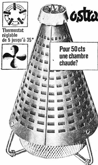
**Ostra** Un ventilateur aspire par le haut l'air froid de la chambre. Le radiateur chauffe instantanément l'air aspiré à 50-70°C en répandant la chaleur vers le bas, de sorte qu'une pièce de 4x4 m (30-40 m<sup>3</sup>) est vite et uniformément chauffée à 18-20°C jusque dans les moindres recoins.
