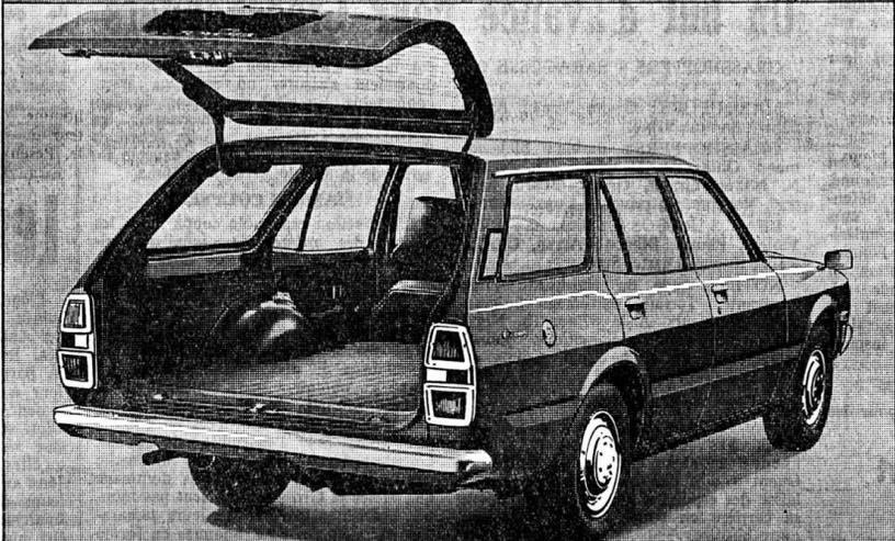
Double circuit de freinage assisté, lunette arrière chauffante, signal de détresse, pneus radiaux, témoin de freins et de frein à main, auto-radio, sièges-coucheffes individuels à l'avant avec appuie-tête incorporés, ceintures de sécurité à 3 points d'ancrage, charge utile d'environ 475 kg, consommation (normes DIN), 8,5/100 km.
