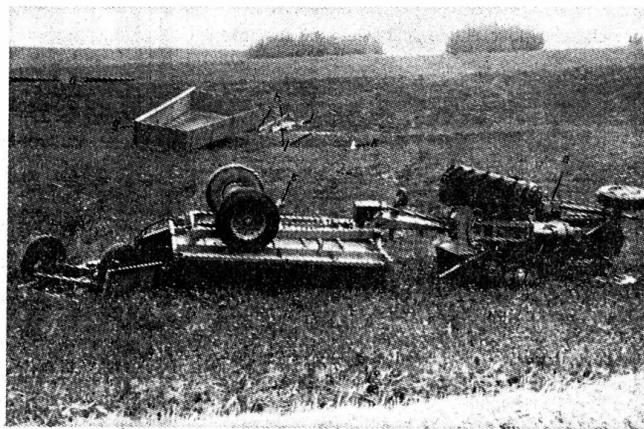
« Encore un tracteur qui se renverse ». La cabine, le cadre ou l'arceau de sécurité permettent au conducteur d'être presque toujours indemne, lorsque la machine se renverse.
