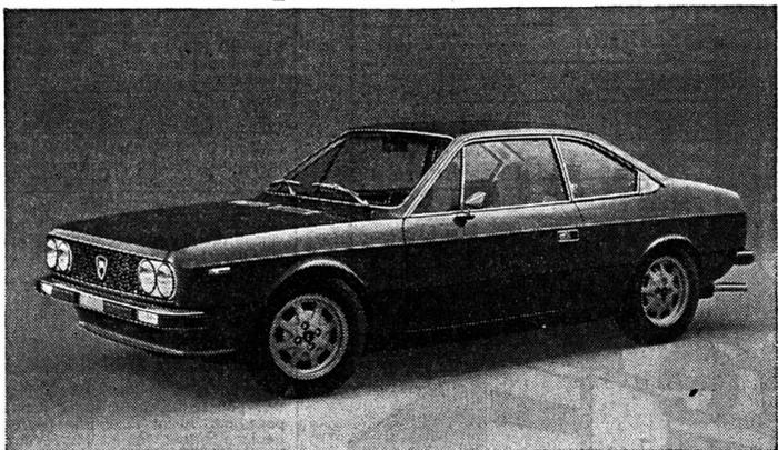
La Lancia Beta Coupé est une traction avant, suspension indépendante à l'avant et à l'arrière, avec freins à disque sur les 4 roues, et offre le choix entre 2 moteurs: 108 CV (DIN) et 120 CV (DIN). L'accélération de 0 à 100 km/h est de 10,2 sec. et 9,5 sec. resp. Tout ceci pour vous montrer que la Beta Coupé est aussi sportive que ses concurrentes les plus chères.
