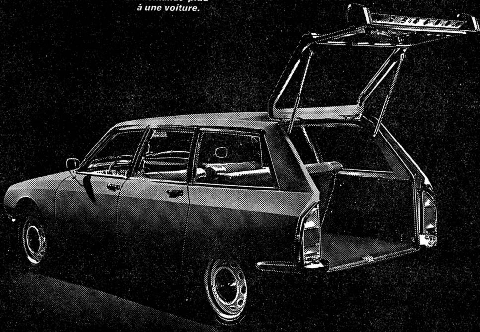
4 cylindres opposés à plat, refroidissement à air, 2 arbres à cames en tête. Traction avant. 4 roues indépendantes. Suspension hydro-pneumatique à hauteur réglable et correcteur d'assiette. 4 freins à disque assistés avec répartiteur de charge. Berlina, break, modèle Club (exécution plus luxueuse).
