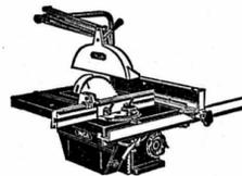
table, 520 x 520 mm, extensible à 520 x 650 mm, hauteur de coupe, 80 mm, avec guide parallèle, 1 lame, 250 mm  $\phi$ , 2 flasques obliques, clés et dispositif de protection
