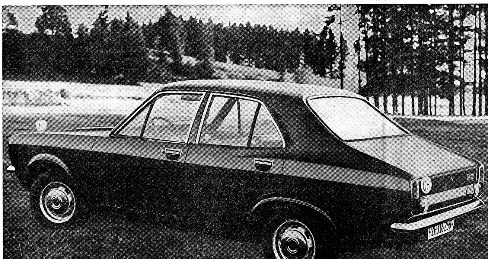
Sunbeam 1250 52 CV/DIN, 1248 cm 3 , coffre géant, double circuit de freinage assisté, sièges indépendants à l'avant, large banquette à l'arrière, dispositif de sécurité-enfants.
