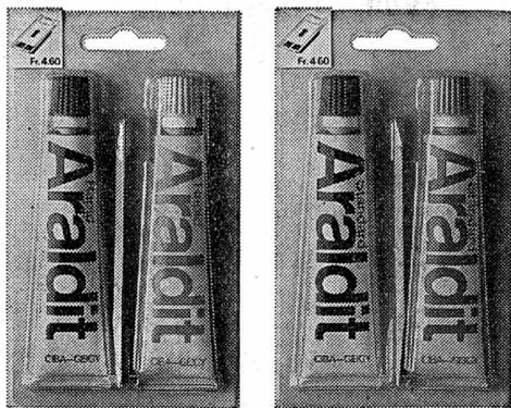
Araldite Rapide (rouge) convient particulièrement aux petits travaux. Car le mélange peut être travaillé que pendant 6 à 8 minutes. Au-delà de ce délai, il commence à durcir. 10 minutes après l'assemblage, le joint est autoportant. Au bout de 2 à 4 heures, il peut être mis en service.
