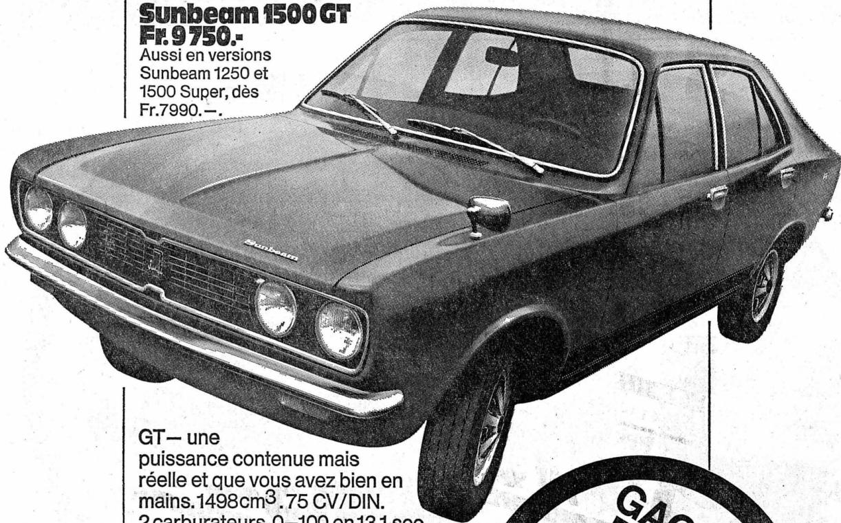
GT — une puissance contenue mais réelle et que vous avez bien en mains. 1498cm<sup>3</sup>. 75 CV/DIN. 2 carburateurs. 0-100 en 13,1 sec. Vitesse de pointe 159 km/h. GT — un tableau de bord richement équipé. Freins à disque assistés à l'avant. Intérieur d'une élégance sportive, d'un confort inattendu. GT — la voiture conçue pour familles sportives.
