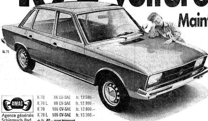
Moteur avant avec refroidissement à eau. Traction avant. 4 roues indépendantes. 4 portes. Contenance du coffre 700 litres.
