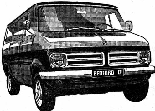
Bedford CF - moteur 2 litres, 102 CV (SAE) à essence normale - livrable en fourgon, bus (10 ou 13 places), avec pont métal léger ou en châssis/cabine (pour carrosserie adaptée à vos besoins) - charge utile jusqu'à 1200 kg - 4 vitesses synchronisées - alternateur 12 V.
