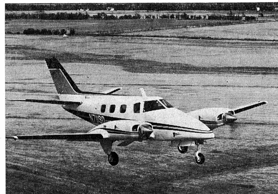
Un beechcraft « Duke » à l'atterrissage. Ce bimoteur de 4 à 6 places est doté de deux moteurs à turbocompresseurs de 380 CV. Il vole à plus de 400 km/h.
