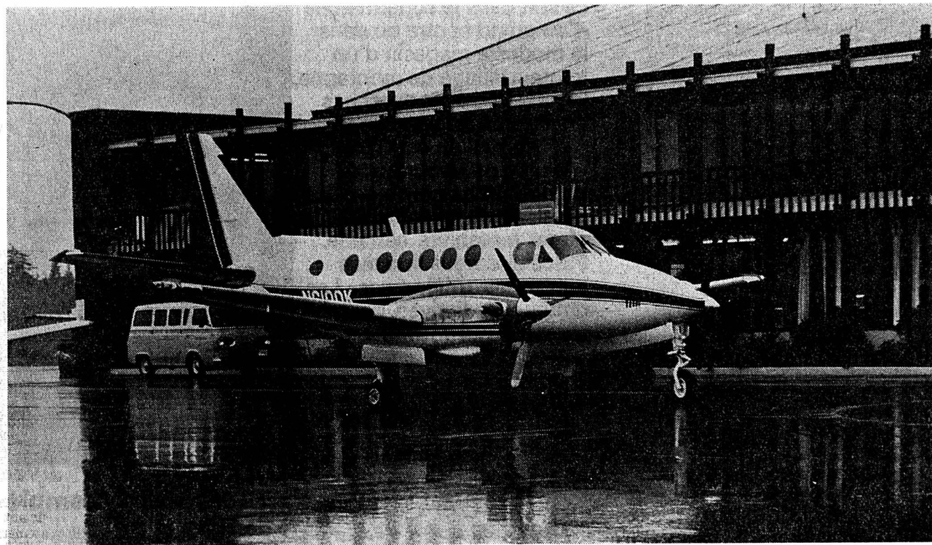
Le nouveau bimoteur à turbines King Air 100 de Beechcraft est équipé de deux moteurs de 680 CV chacun. Il emporte de 9 à 15 passagers à plus de 400 km/h. Il atterrit sans difficulté... et sans bruit sur des pistes de 600 mètres.
