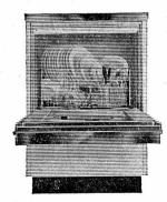
Machine à laver la vaisselle Schulthess SG/6. Capacité: 6 services de table ordinaires. Les divers programmes de lavage et derinçage sont commandés par cartes perforées. Système d'aspersion à 6 gicleurs, panier à vaisselle rotatif décuplant la puissance de lavage. Cycles de lavage très courts. En-
