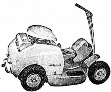
L'autotondeuse « JAVELIN » 6 CV, Fr. 2700.—; largeur de tonte 66 cm, vitesse 1 à 8 km/h
