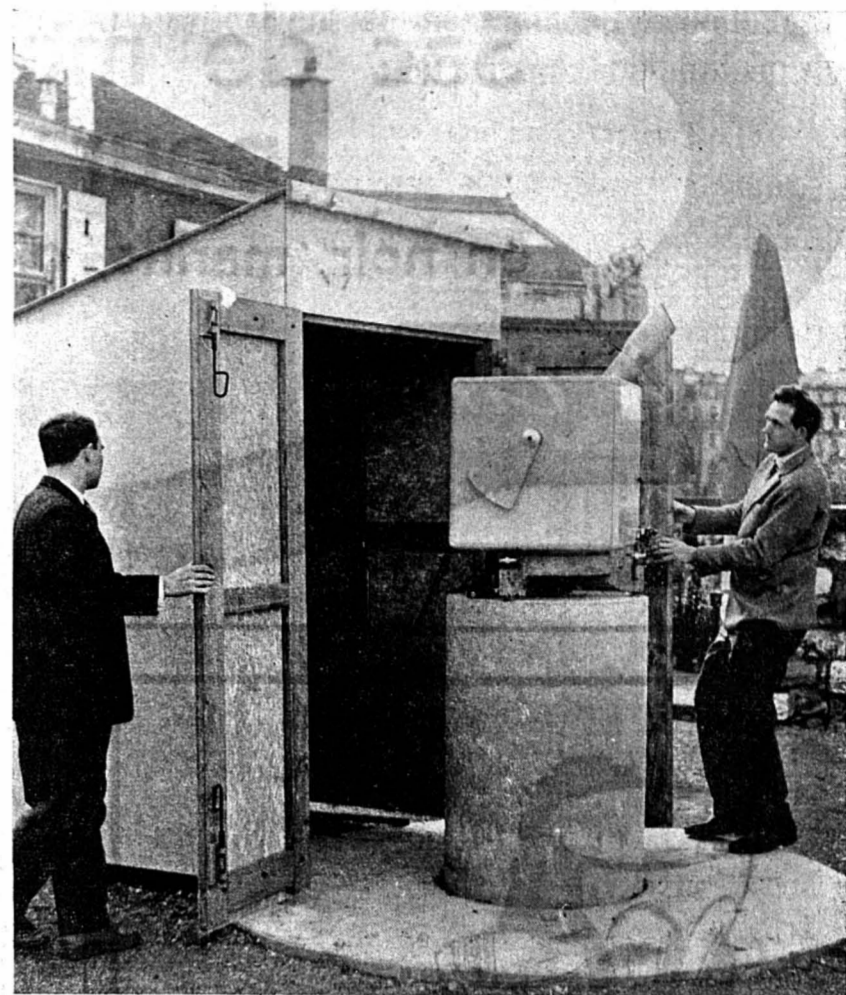
Pour la première fois en Suisse, un appareil appelé «théodolite» a été mis en service à un observatoire. C'est à Genève qu'il a été inauguré et il sera utilisé pour l'observation des satellites gravitant autour de notre planète. Ce théodolite a été entièrement conçu à l'Observatoire de Genève.
