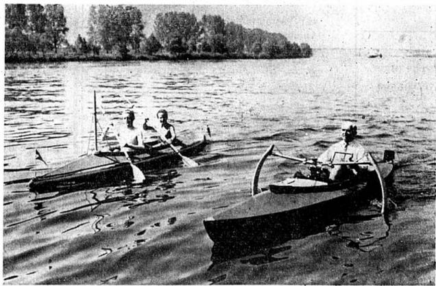
L'ingénieur Friedrich Budig, d'Offenbach, vient de mettre au point un canoë dont les rames sont actionnées par les pieds. Sur notre photo, nous voyons l'ingénieur, sur le Rhin, battre avec sa nouvelle embarcation un canoë conventionnel.
