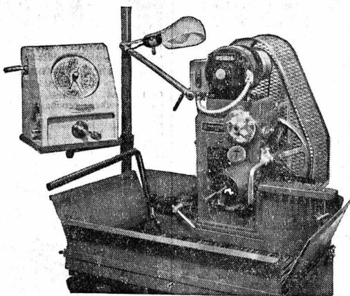
Machine à honer SUNNEN combinée avec micromètre MERCER
