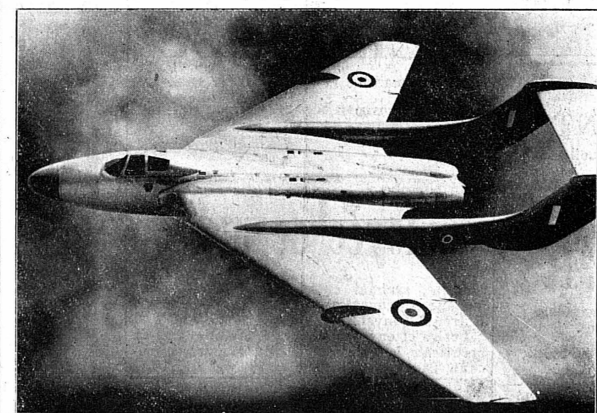
Voici une photographie du nouvel avion à réaction anglais, le chasseur « D. H. 110 », dont nous avons donné récemment les caractéristiques. Rappelons que cet appareil est le premier biplace capable de dépasser la vitesse du son. Durant les essais, il a volé à 1200 kmh.
