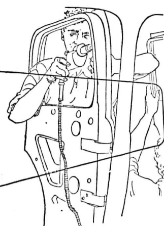
Pose des cadres de glaces et des garnitures de portières.
