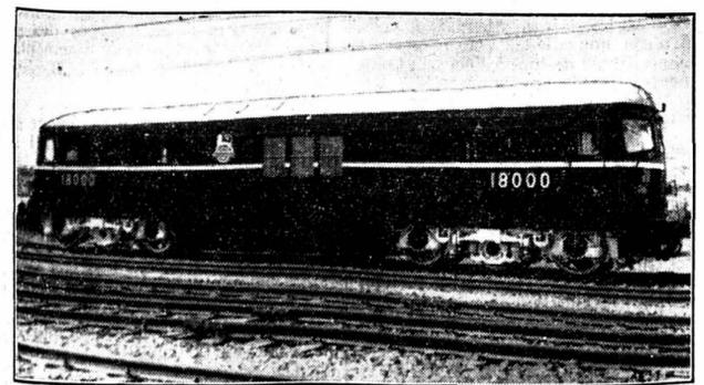
Les usines Brown-Boveri et la Fabrique suisse de locomotives et machines, à Winterthur, ont construit une nouvelle locomotive mue par une turbine à gaz, qui est destinée aux chemins de fer britanniques. Cette machine, d'un poids de 117 tonnes, développe une force de 2500 chevaux et atteint la vitesse de 87 milles à l'heure (140 km. environ).
