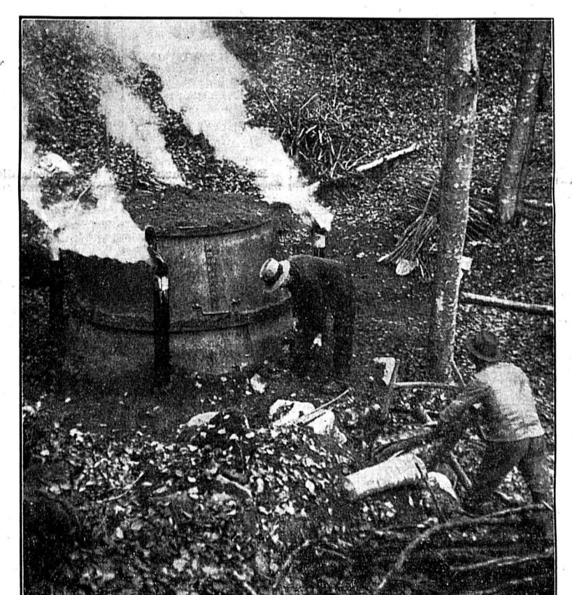
En divers endroits — et notamment aux Verrières — des exploitations de carbonisation du bois ont été ouvertes, remettant ainsi en honneur le métier de charbonnier. — Voici, par exemple, à Ollon, un four en activité. Un des charbonniers règle le tirage, tandis qu'un de ses collègues coupe du bois pour la prochaine opération.
