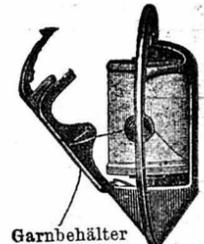
Garnbehälter mit eingesetzter Unterfadenrolle in verkleinertem Massstab.
