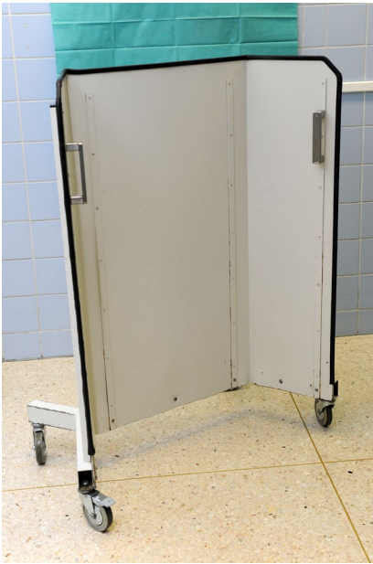
Abb. 2 ◀ Fahrbare Bleiwand mit durchgehender 2-mm-Bleibschirmung: Modernere Modelle bieten auch ausziehbare Bleiglas-scheiben. Fahrbare Bleiwände sind ideal zum zusätzlichen Schutz von Assistenten und Operationssaalpersonal, z. B. bei beidseitigem Arbeiten oder ggf. auch für den Anästhesiearbeitsplatz
