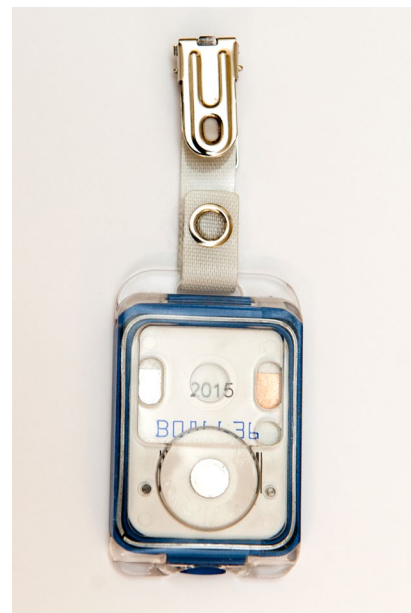
Abb. 6 ▲ Amtliches Körperdosimeter, welches monatlich abgelesen werden muss
