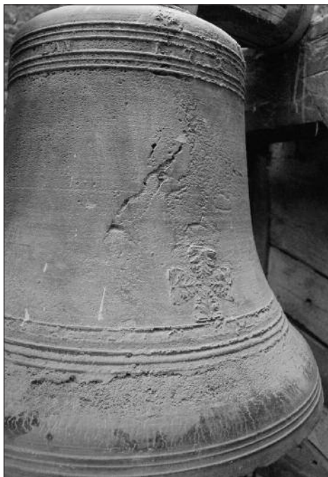
Fig. 6. Hospice du Grand-Saint-Bernard. Le vase de la petite cloche de 1728 sur lequel on peut observer les défauts de surface dus à l'humidité contenue dans le moule.
