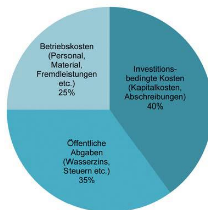
Bild 1: Typische Kostenstruktur eines grossen Wasserkraftwerkes.
